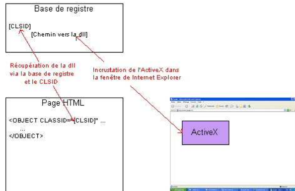
Fig. 3. Incrustation d'un contrôle ActiveX dans une fenêtre Internet Explorer
