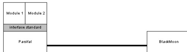
Fig. 6. Principe de la modularité dans Parsifal
