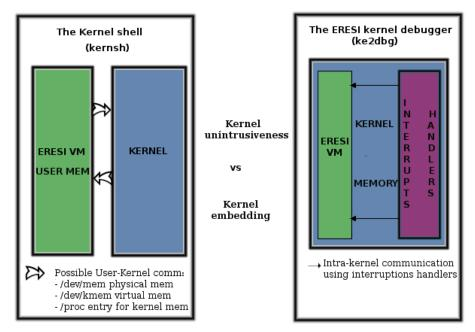
Ke2dbg est un debugger modulaire à la rr0d, car il ne nécessite pas de patcher les sources du noyau, se lançant donc comme une module noyau. Il ne requiert pas également une autre machine pour debugger. Le code réside entièrement en espace noyau, et ne nécessite donc aucune communication avec l'espace utilisateur. l'intéraction avec ce dernier est effectuée avec une prise en charge basique du clavier et de l'écran.
